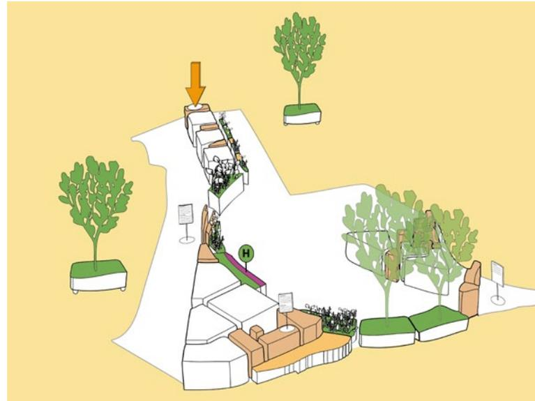
Eine Rampe sorgte für einen barrierefreien Zugang ins Innere. Das Hauptmodul diente als Bühne, Workshop-/Ausstellungsraum, in dem das digitale Angebot wettergeschützt untergebracht wurde sowie als Aufbewahrungsraum für die Einzelmodule über Nacht.
